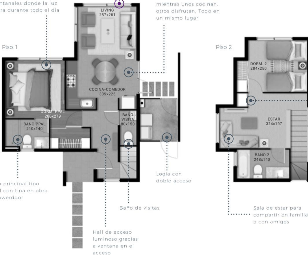
1<sup>er</sup> piso: 42,58 m<sup>2</sup> | 2<sup>do</sup> piso: 27,14 m<sup>2</sup> | Superficie total: 69,72 m<sup>2</sup>
